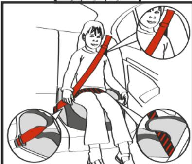
● Поставьте автокресло по ходу движения автомобиля на заднее или переднее сиденье автомобиля.
