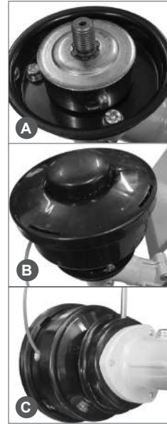
Рис. 6 Установка триммерной головки
