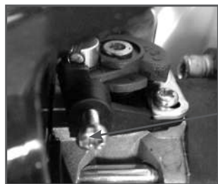
Рис. 16 Винт настройки оборотов холостого хода
