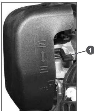
Рис. 9 Расположение воздушной заслонки
