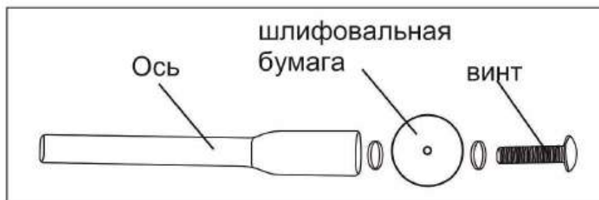
Рис.5 Установка диска из шлиф бумаги
