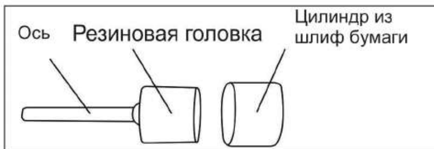
Рис.6 Установка цилиндра из шлиф бумаги
