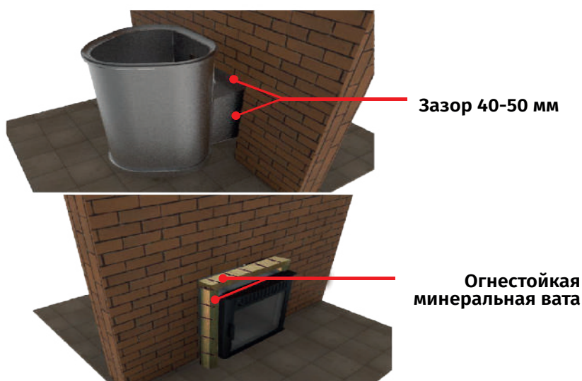
Рис.№ 5 Установка печи «Сквозь стену»
