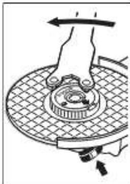
Должным образом затянутую, исправную быстрозажимную гайку можно открутить поворотом кольца с накаткой от руки против часовой стрелки. Никогда не применяйте для откручивания заклинившей быстрозажимной гайки клемши, обязательно используйте рожковый ключ под два отверстия. Накладывайте рожковый ключ под два отверстия, как показано на рисунке.
