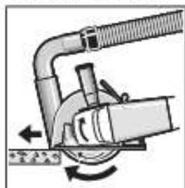
Включите электроинструмент и приставьте переднюю часть направляющих салазок к обрабатываемой заготовке. Ведите пневматический инструмент с равномерной, рассчитанной на обрабатываемый материал подачей.
