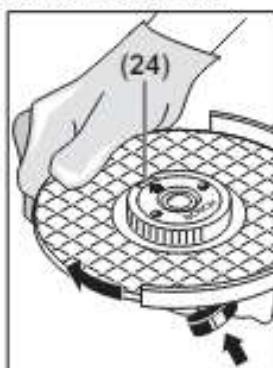
Для фиксирования шлифовального шпинделя нажмите кнопку фиксирования шпинделя (1). Чтобы затянуть быстрозажимную гайку, поверните шлифовальный круг с усилием по часовой стрелке.
