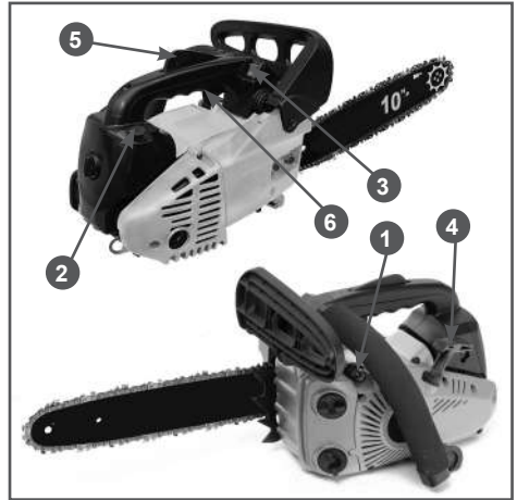
Рис. 10 Органы управления, необходимые для запуска бензопилы
