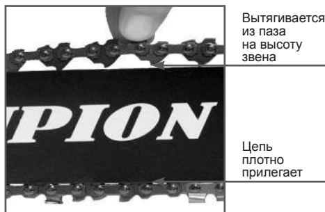
Рис. 5 Регулировка натяжения цепи
