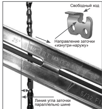
Рис. 28 Определение угла заточки
