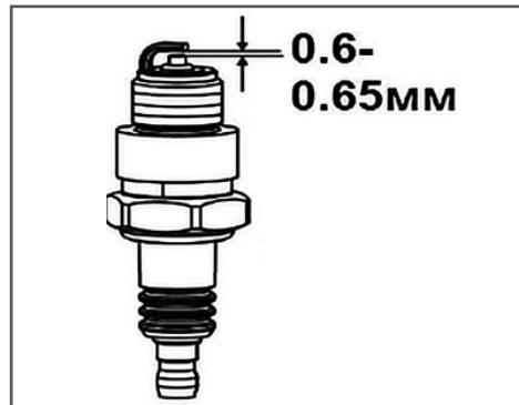
3. Проверьте свечу зажигания. Если электроды изношены или повреждена изоляция, замените свечу.
