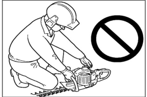
Рис. 4 Неправильное положение оператора при запуске двигателя
