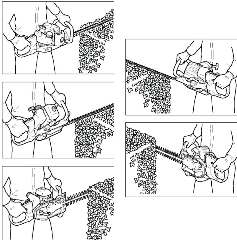
Рис. 7 Положение режущих ножей и задней рукоятки
