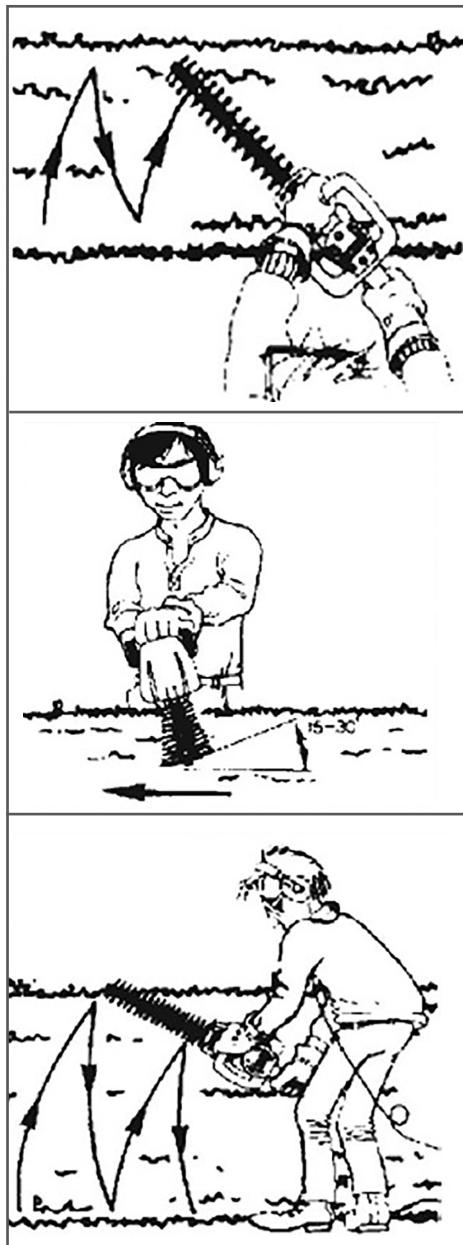
Рис. 5 Движения ножницами при обрезке
