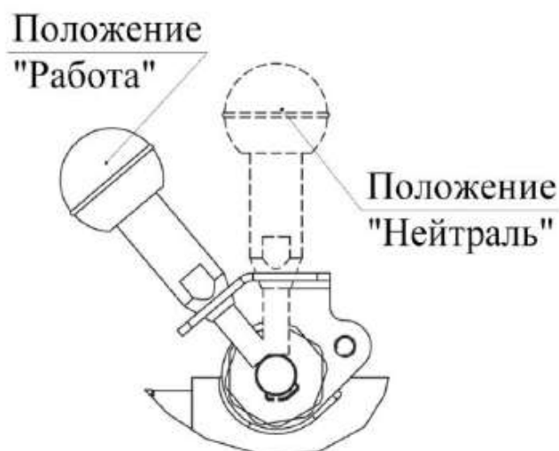
Рисунок 10 – Механизм включения косилки к мотоблоку «Угра».
