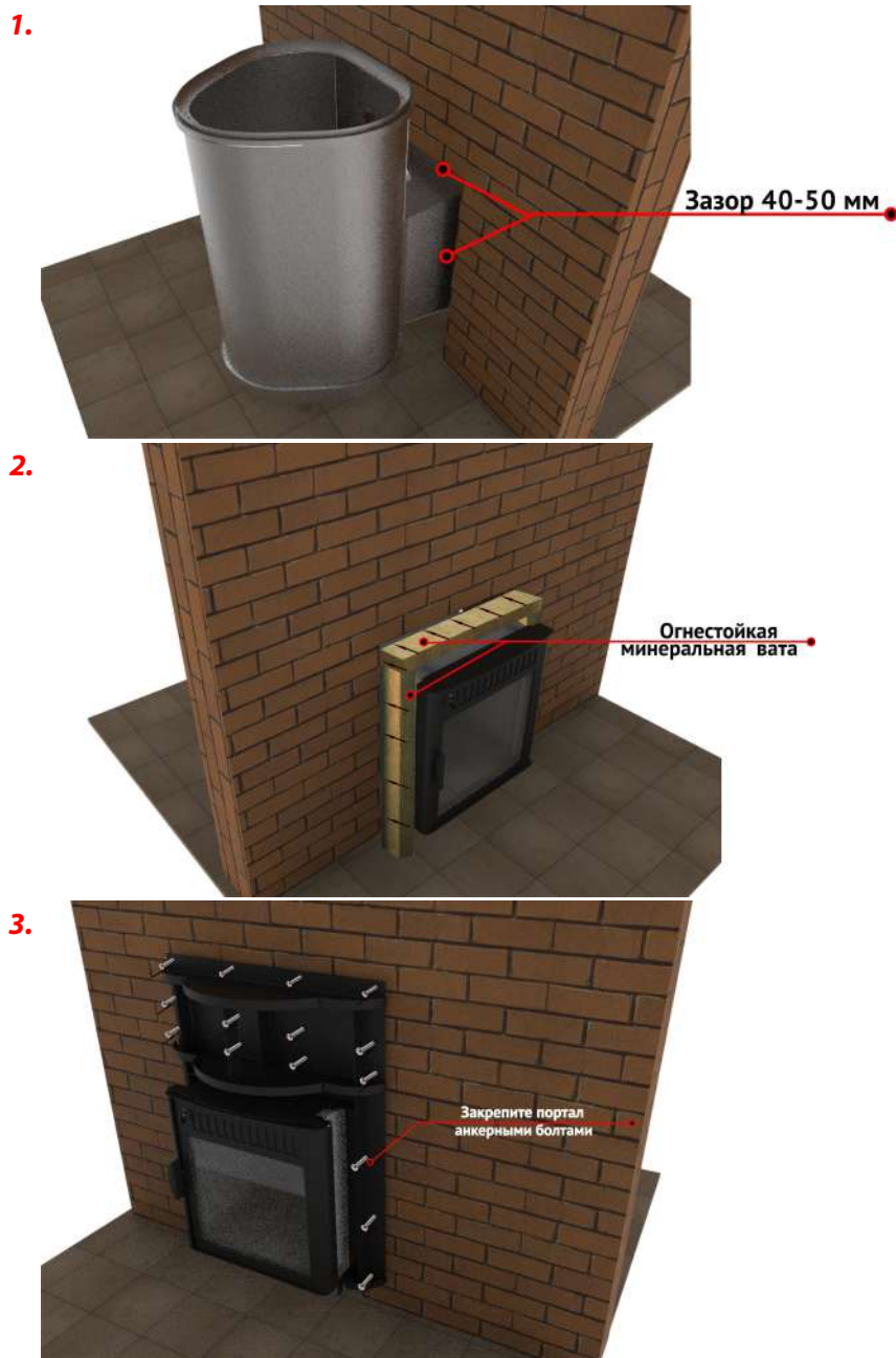
Рисунок 8.2. Схема установки печи
