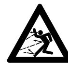
Ни в коем случае не направлять воздушную струю на других людей или животных – устройство может отбрасывать небольшие предметы с большой скоростью – **опасность травм!**
