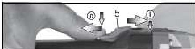
**Включение:** сдвинуть переключатель (5) вперед. Для непрерывной работы нажать переключатель вниз до фиксации.
