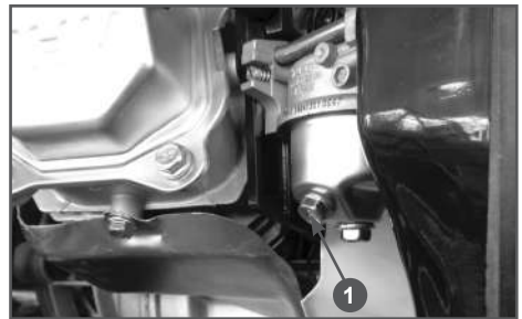
Рис. 20 Слив топлива из карбюратора 1. Болт сливной
