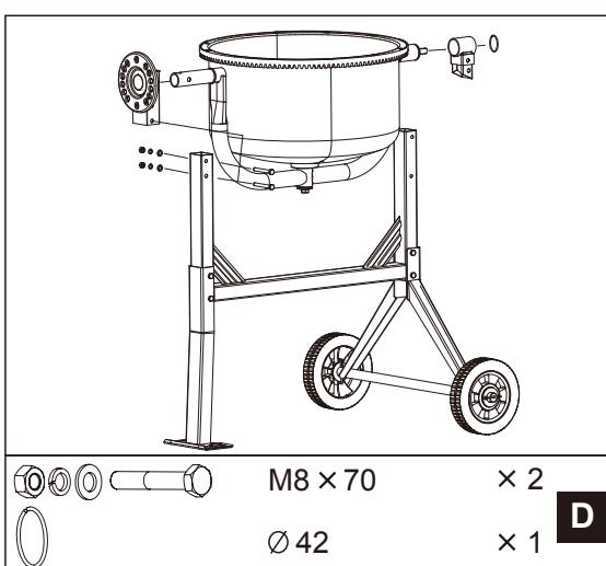
1. Надвиньте подшипниковый узел-правый на вал, застопорите его спиральным кольцом Ф42мм. Надвиньте подшипниковый узел-левый на вал с другой стороны
