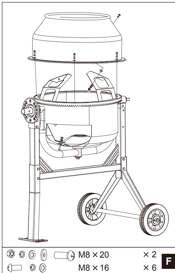
1. Установите верхний барабан на нижний над ободом таким образом, чтобы совместились монтажные отверстия, а также стрелки в обоих частях.
