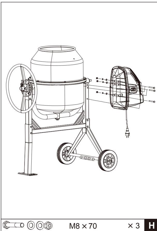
Совместив шпоночные пазы, надвиньте коробку с редуктором на вал шестерню. Закрепите коробку на раме тремя гайками M8x70 с одной стороны, затем зплоскими шайбами, пружинными шайбами и гайками с другой стороны.
