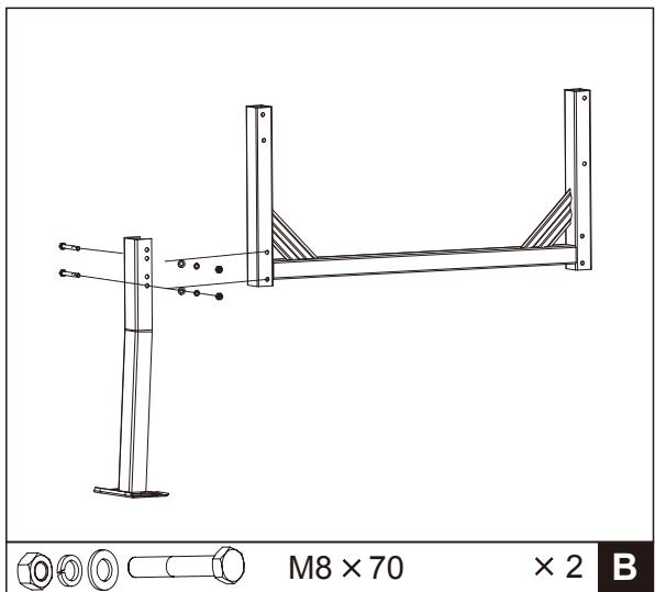
2. К раме, лежащей на боку, прикрепите опорную ногу, как показано на рисунке. Вставьте 2 болта M8x70 с шестигранной головкой в отверстия с одной стороны, затем поставьте плоские шайбы, стопорные шайбы и гайки. Затяните.
