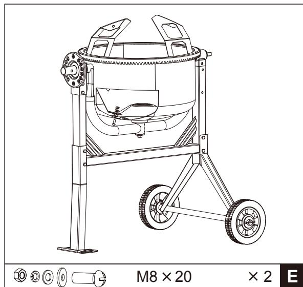
Смонтируйте смесительные лопасти внутри нижнего барабана, как показано на рисунке, предварительно с люфтом. В донной части барабана имеются два отверстия, в которые вставляются снаружи болты M8x20. Изнутри на них надевается кожаная шайба, плоская шайба, стопорная шайба и навинчивается гайка, но не до конца. Кожаная шайба помещается между лопаткой и барабаном.
