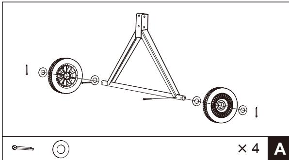
1. Вставьте шплинт в каждое ближнее к центру отверстие в оси, наденьте на ось шайбы с обеих сторон, затем наденьте колёса, затем ещё шайбу с каждой стороны и ещё по шплинту с наружной стороны. Отогните концы шплинтов.
