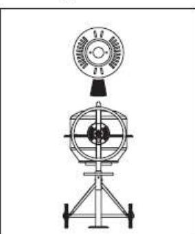
Барабан фиксируется в позиции с помощью зубцов на колесе наклона, которые входят в зацепление с фиксирующей тарелкой на раме смесителя.
