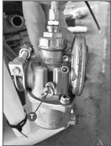
Рис. 16 Расположение винтов регулировки карбюратора
