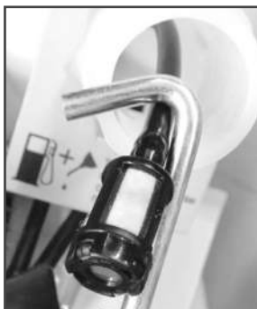
Рис.10 Извлечение топливного фильтра
