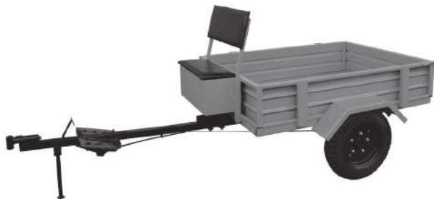
Соединение прицепа с мотоблоком осуществляется при помощи дышла и металлического пальца. Вес перевозимого груза в среднем составляет до 250 кг, скорость транспортировки до 10 - 12 км/ч на второй передаче. На мотоблок необходимо установить пневматические штатные колеса.
