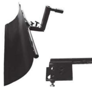
Монтаж для мотоблока «Самара» - присоедините отвал на коннектор крепления навесного оборудования. Угол наклона в левую и правую стороны устанавливайте с помощью фиксаторов. Монтаж на мотоблок «Самара М» - снимите с мотоблока транспортировочное колесо, установите адаптер и присоедините отвал. Угол наклона в левую и правую стороны устанавливайте с помощью фиксаторов.
