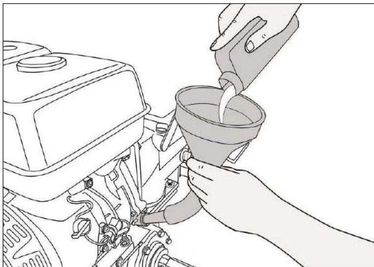
Рис. 11. Доливка масла в двигатель
