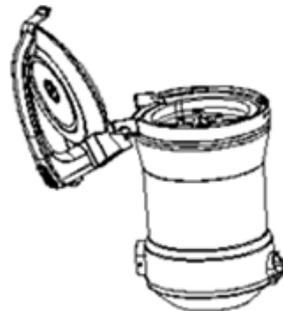
Снимите контейнер для сбора пыли. Откройте верхнюю крышку контейнера. Извлеките фильтр двигателя.
