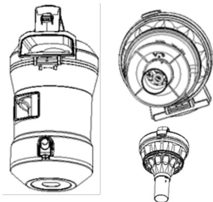
Снимите контейнер для сбора пыли. Поверните верхнюю часть фильтра и извлеките составные части циклонного фильтра. Проведите их чистку, а затем снова соберите фильтр и установите контейнер обратно на пылесос.
