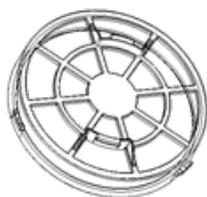
Извлеките фильтр и почистите его щеткой. При сильном загрязнении промойте его прохладной водой под краном. Запрещается мыть фильтр горячей водой или использовать для его мытья моющие средства. Запрещается стирать фильтр в стиральной машине.
