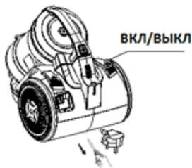
2. Подключите вилку питания к электрической розетке и нажмите кнопку включения/выключения
