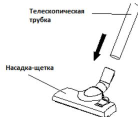
4. Установите на трубку подходящую насадку.
