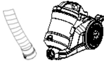
1. Выровняйте гибкий шланг относительно воздухозаборного отверстия на корпусе пылесоса, а затем вставьте его в отверстие до фиксации.
