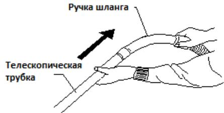
2. Соедините телескопическую трубку с ручкой гибкого шланга.
