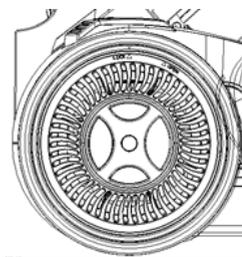
Снимите воздуховыпускную решетку на колесе, повернув крышку фильтра по стрелке в направлении «OPEN».
