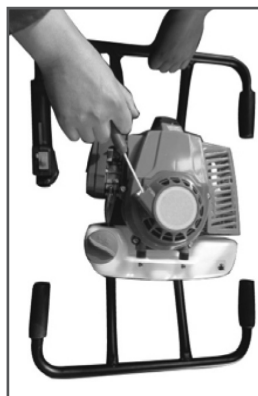
Рис. 9 Свободный ход шнура стартера
