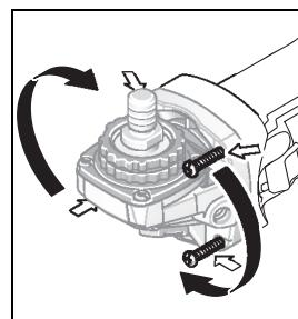
Вы можете повернуть редукторную головку шагами в 90°. Этим выключатель может быть поставлен в удобное для работы положение, например, для левши. Полностью выверните 4 винта. Осторожно поверните редукторную головку **без отрыва от корпуса** в новое положение. Крепко затяните 4 винта.
