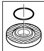
**Посадочный фланец для шпинделя M 14:** На опорном фланце **9** вокруг центрирующего буртика находится пластмассовая деталь (кольцо круглого сечения). Если кольцо круглого сечения отсутствует или повреждено, опорный фланец **9** необходимо обязательно заменить перед дальнейшим применением.
