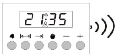
1) Будильник включается при истечении заданного времени на таймере
