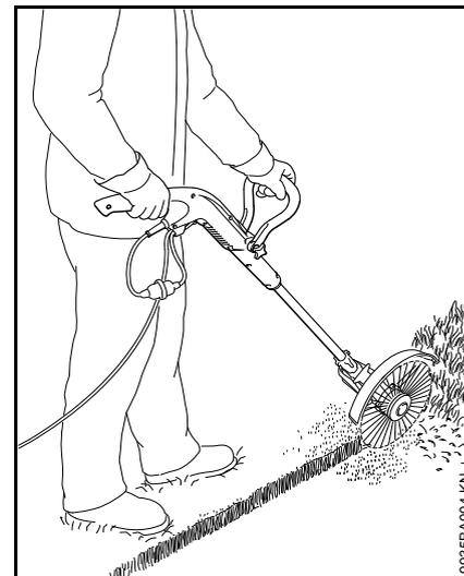
Агрегат за несколько приемов может быть переоборудовано в кромкорез (см. "Переоборудование агрегата в кромкорез").
