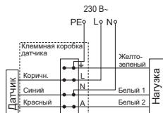
Рисунок 18 – Схема подключения датчиков ДД-017, ДД-019
