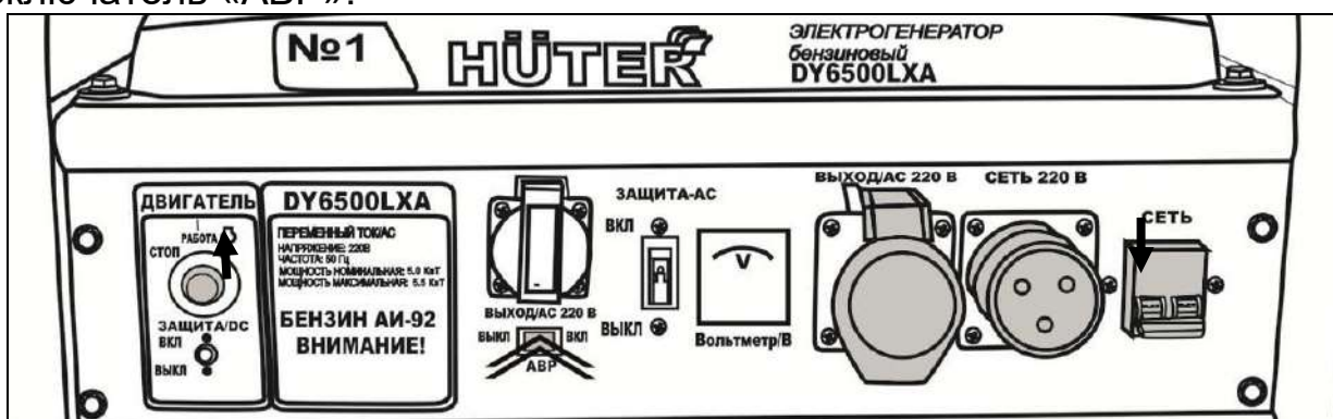
Рис. 25. Панель генератора с встроенным АВР.
