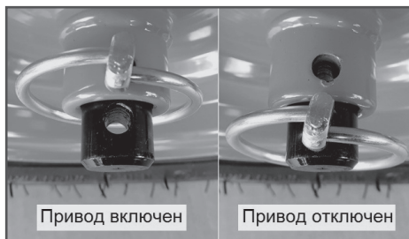
Рис.10 Перестановка шплинта на левом колесе
