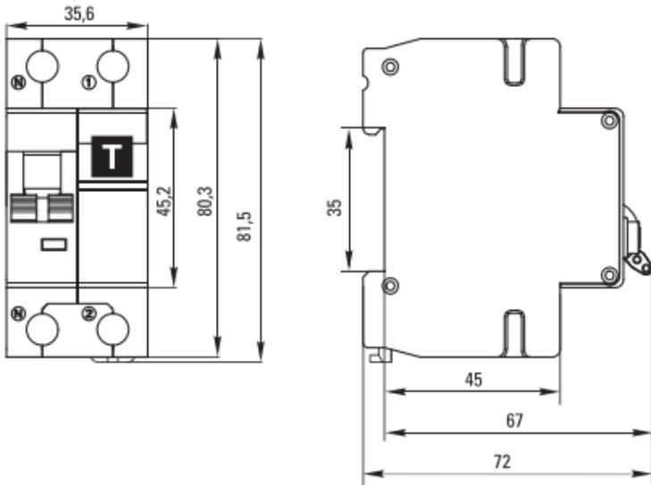
Рис.2 Габаритные размеры АВДТ-63
