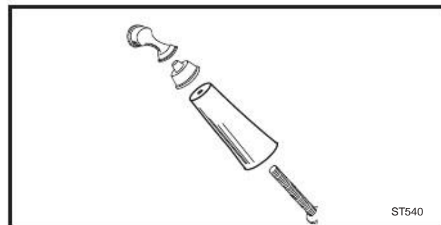
Фигура 26. Сборка ручки дверцы.
