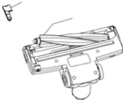
После очистки установите ролик со щетиной в обратном порядке. Ролик может быть установлен только в том же положении, в котором вы его сняли. В неправильном положении вы не сможете установить ролик на свое место.
