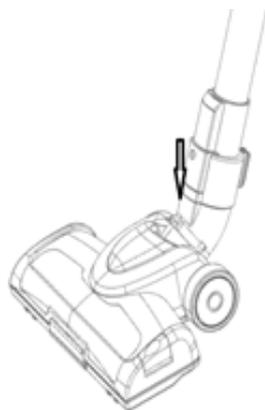
2. Выровняйте удлинительную трубку относительно моторизованной щетки, как показано стрелками на рисунке, и с усилием вставьте трубку в отверстие щетки, чтобы раздался щелчок.
