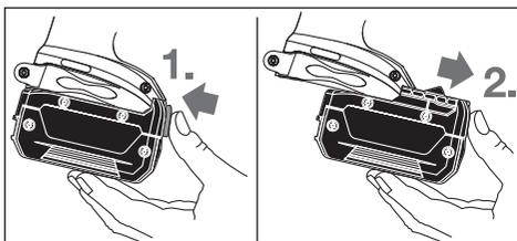
Чтобы извлечь аккумуляторную батарею (3), нажмите на кнопку разблокировки (4) и извлеките аккумуляторную батарею из электроинструмента, потянув ее назад. **Не применяйте при этом силы.**
