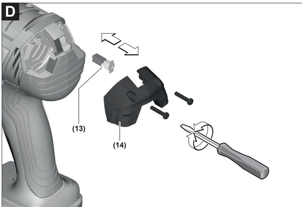
**Figyelem:** Csak a Boschnál kapható, az Ön berendezéséhez előírányozott szénkefét használja.
