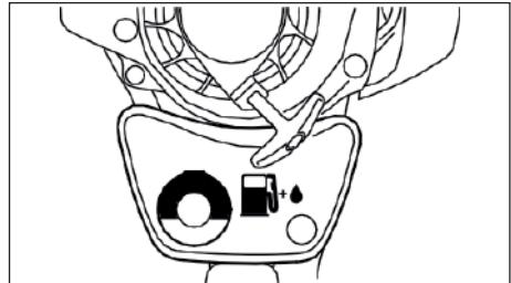
**!** Чтобы снизить риск ожогов или других травм от выходящих газовых паров и дыма, осторожно снимите крышку топливного бака, чтобы медленно сбрасывать любое повышение давления в баке.
