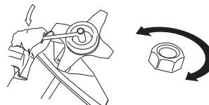
Нейлоновая прокладка контргайки не должна быть изношена настолько, чтобы ее можно было поворачивать вручную. Прокладка должна выдерживать усилие минимум 1,5 Нм. Гайку следует заменить после ее использования приблизительно 10 раз.
