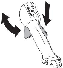
См. указания в разделе Запуск. Включите машину и полностью откройте дроссель. Отпустите рычаг дросселя и удостоверьтесь, что режущее оборудование останавливается и остается неподвижным. Если после постановки дросселя в положение холостого хода режущие оборудование продолжает вращаться, следует проверить регулировку холостого хода карбюратора. См. указания в разделе Техническое обслуживание.
