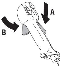
Убедитесь, чтобы рычаг дросселя фиксируется в положении холостого хода при освобождении фиксатора рычага дросселя.
