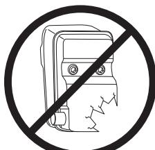
Периодически проверяйте надежность крепления глушителя к корпусу инструмента.
