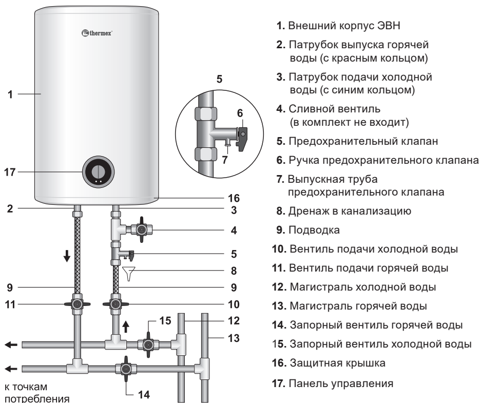
Рисунок 2. Схема подключения ЭВН к водопроводу.
