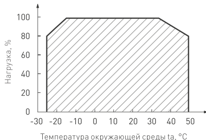
Рис. 2. Максимальная допустимая нагрузка, % от мощности источника
