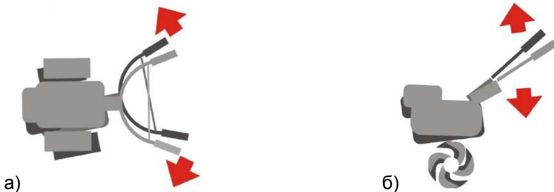
Рис.9. Схемы снятия нагрузки с валов при использовании механизма разобщения полуосей
