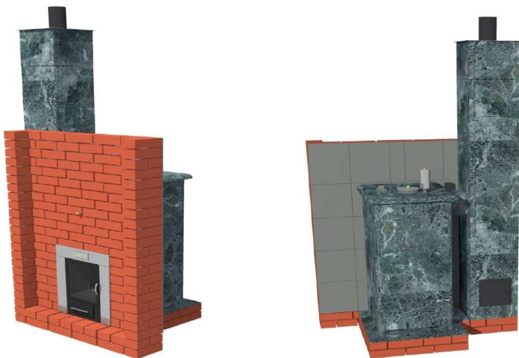
Рис. 7 Пример установки печи с отдельно стоящим дымоходом
