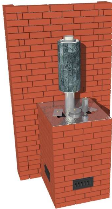
Рис. 10 Пример установки печи в кирпичном кожухе с листом перекрытия
