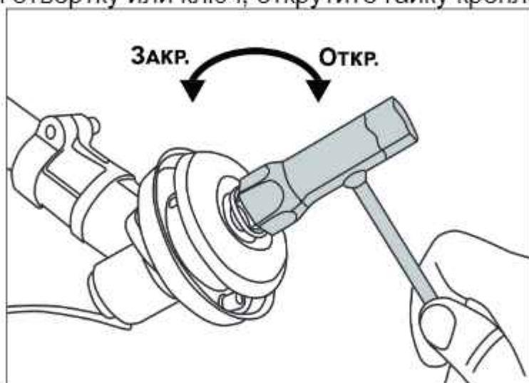
Рис. 9. Откручивание гайки крепления ступицы.
