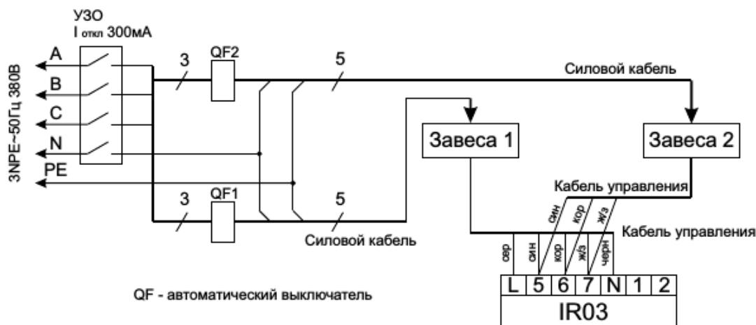
Рисунок 2. Схема подключения более двух завес к одному пульту управления IR03
