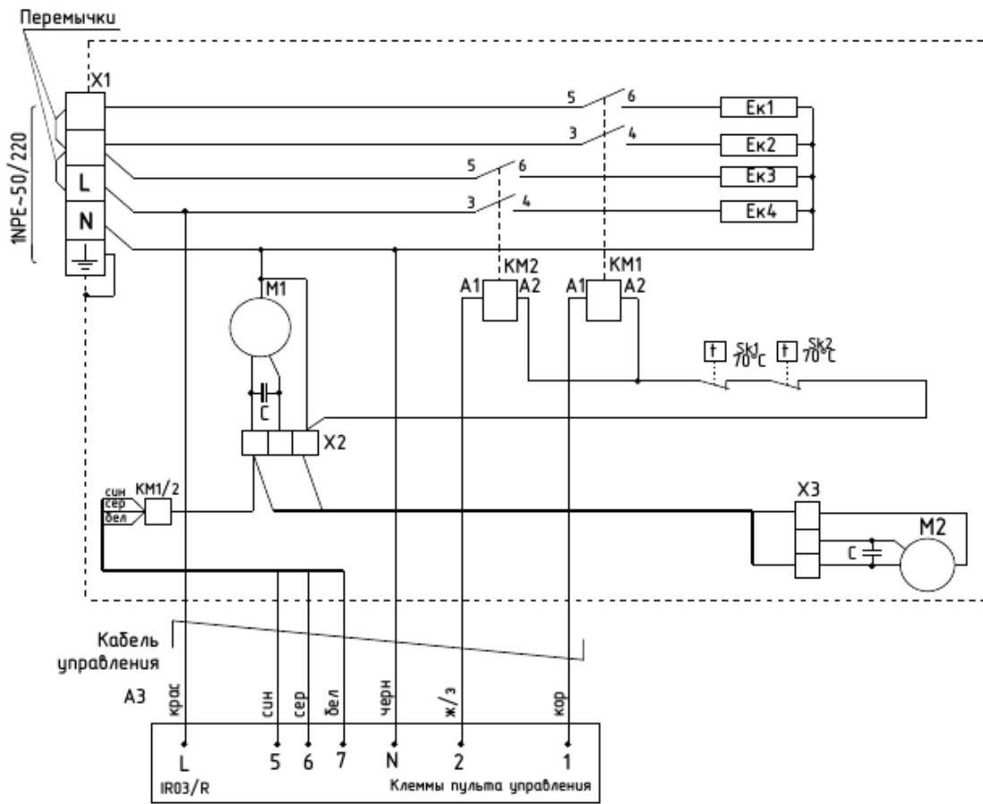
Рисунок 10. Электрическая схема завесы КЭВ-8П1063Е, КЭВ-10П1061Е
