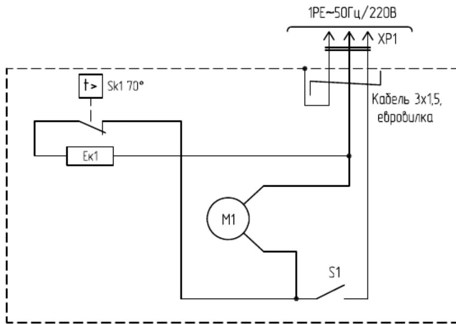
Рисунок 7. Электрическая схема завесы КЭВ-3П1153Е, КЭВ-4П1153Е
