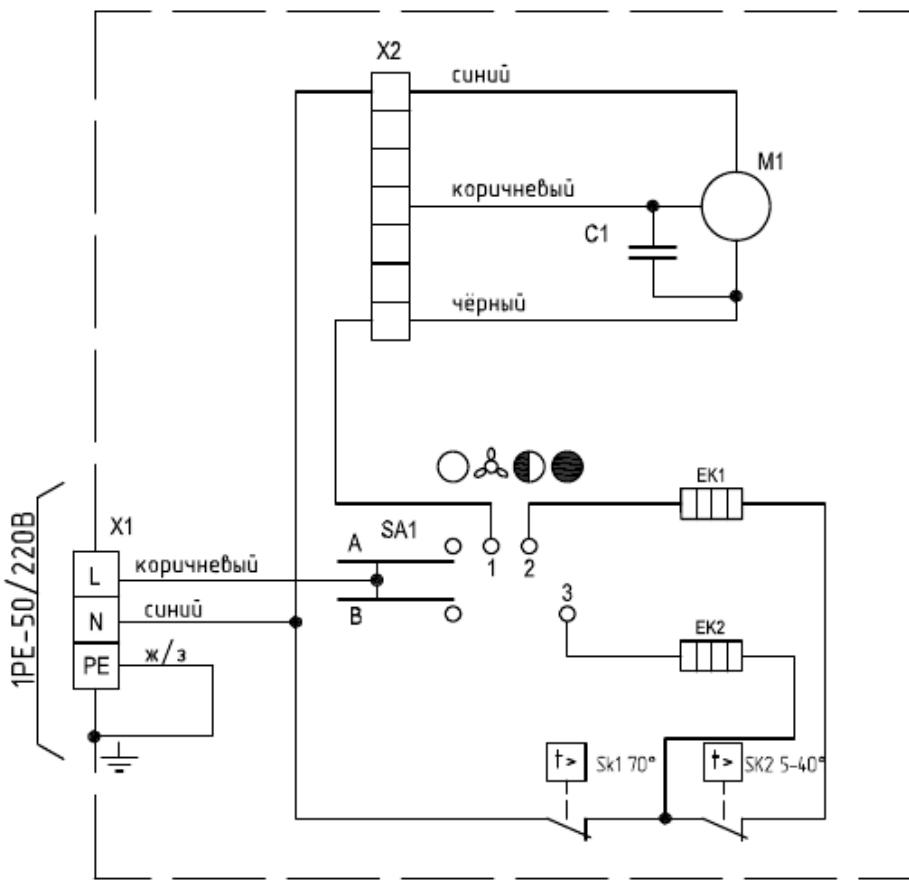
Рисунок 8. Электрическая схема завесы КЭВ-5П1151Е
