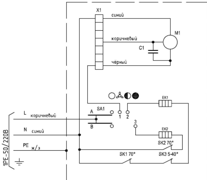
Рисунок 9. Электрическая схема завесы КЭВ-6П1263Е
