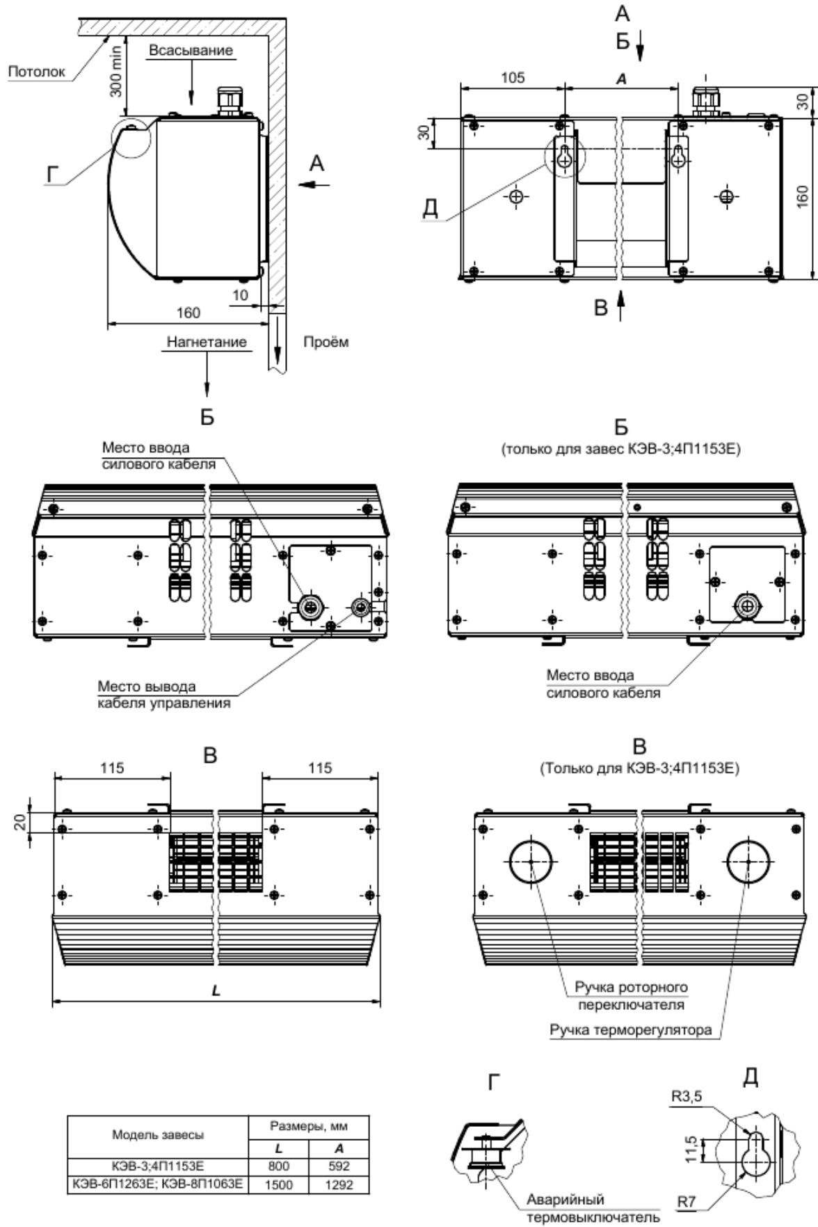
Рисунок 5. Габаритные и крепежные размеры завес
