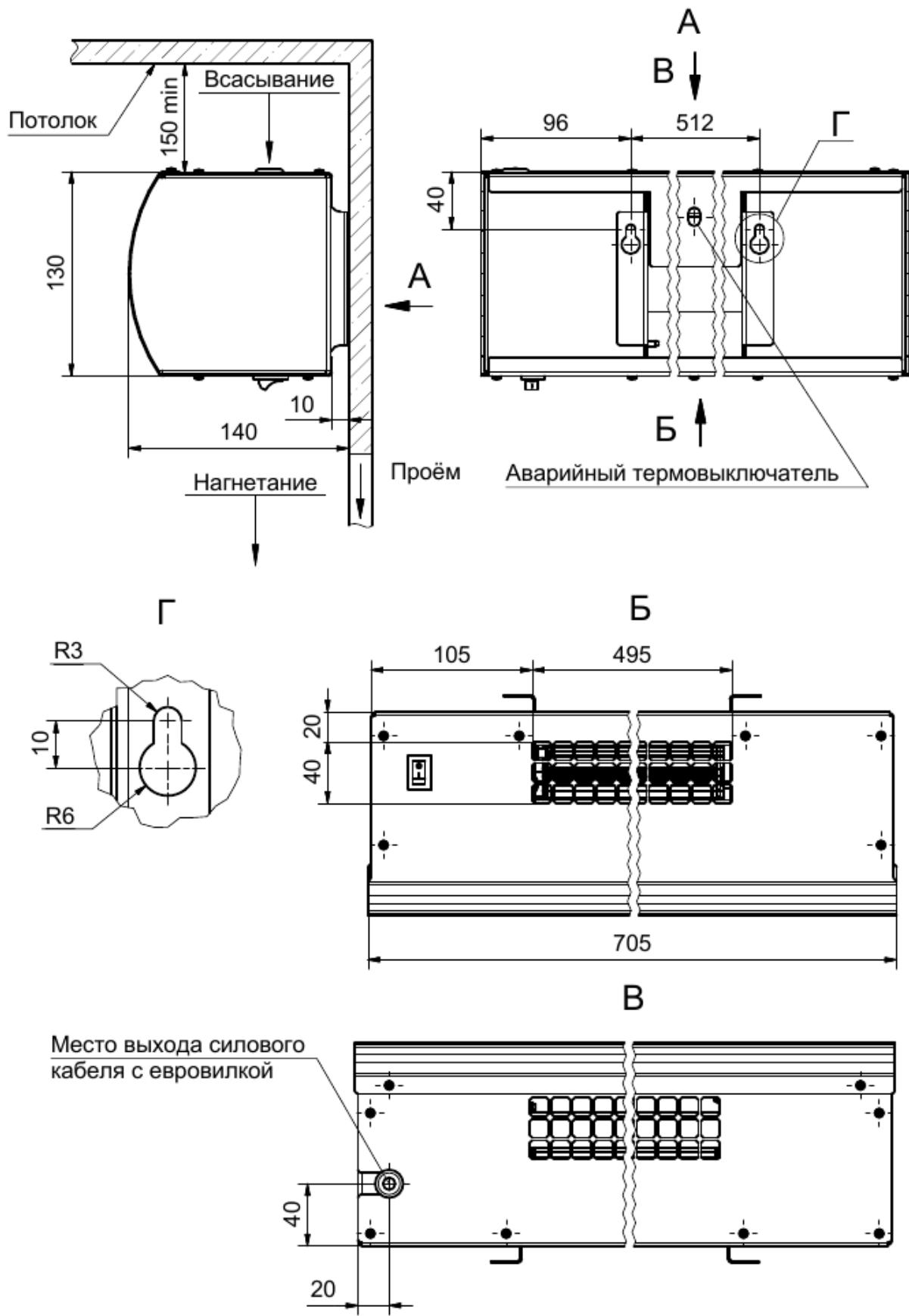
Рисунок 4. Габаритные и крепежные размеры завес «МИНИ»
