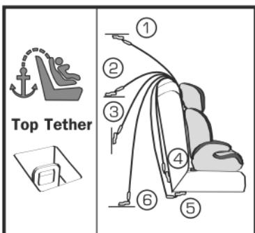
Крепление верхнего страховочного троса ISOFIX в автомобиле обычно представляет собой металлическую скобу, обозначенную Топ Tether.
