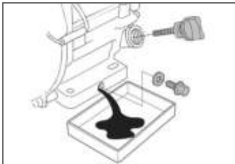
Рис. 24 Замена масла в двигателе
