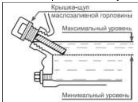
Рис. 15 Проверка уровня масла в картере
