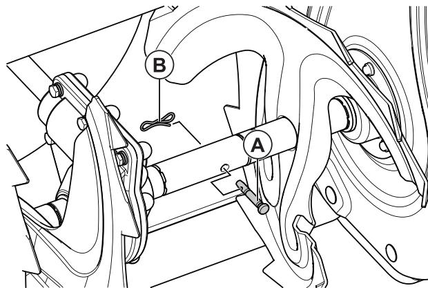
Шнеки крепятся к валу с помощью предохранительных (резьбовых) штифтов со шплинтами или гайками. В случае столкновения шнека с посторонним предметом или ледяным затором, штифты срезаются и шнек перестает вращаться, предотвращая повреждения других частей снегоуборщика. Если шнеки в момент включения не вращаются, то следует проверить, не срезаны ли штифты. При необходимости замените предохранительные штифты.
