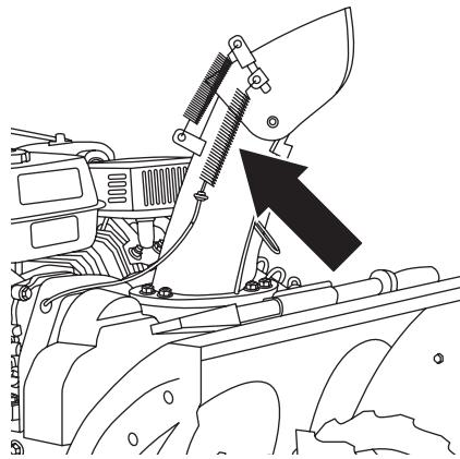
Подключите трос регулировки наклона дефлектора.
