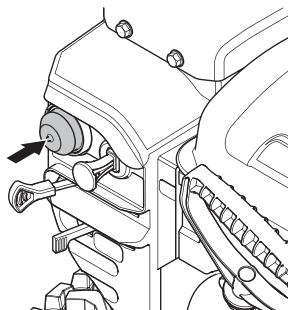
**Примечание!** Для повторного запуска горячего двигателя возможно оставить рычаг воздушной заслонки в положении «**ОТКРЫТО**».
