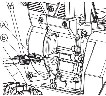
Для комфортного использования снегоуборочной машины она снабжена фонарем освещения и подогревом рукояток. Проделайте подключение электрических кабелей (A) (B) через специальные разъемы. Закрепите токоведущую проводку на нижней рукоятке пластиковыми клипсами, для исключения попадания проводов в зону вращения гусениц.
