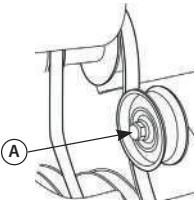
Ослабьте гайку (A), крепления ролика натяжения ремня.
