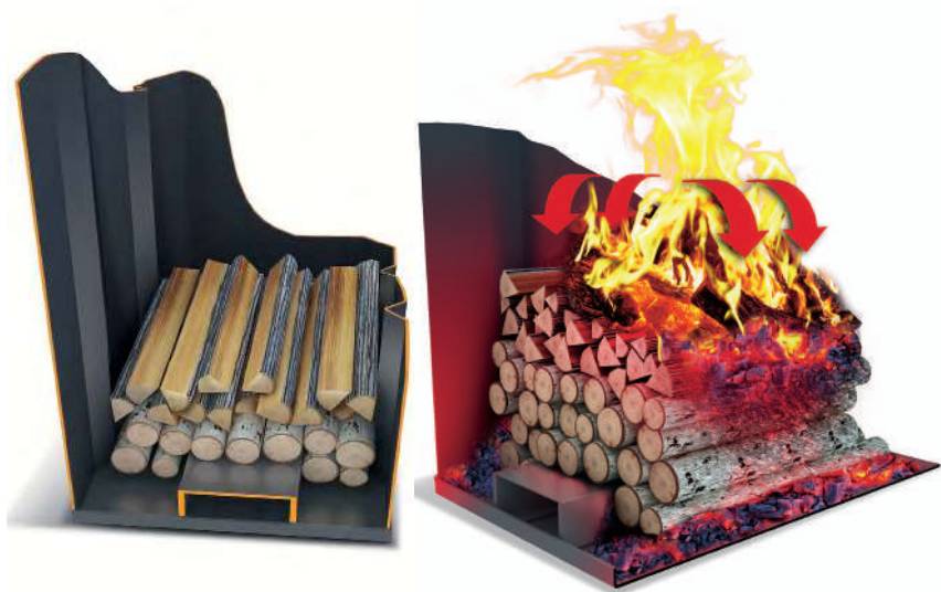
Рисунок 9.5. Варианты закладки дров в топку печи.
