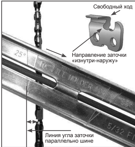
Рис. 16 Определение угла заточки
