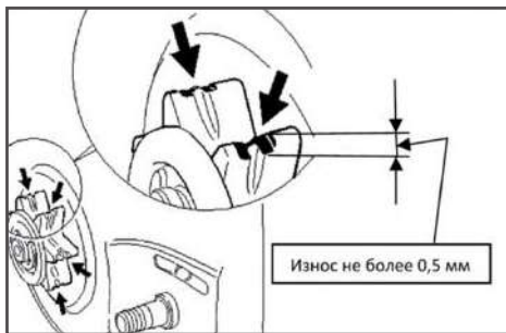
Рис. 14 Проверка износа звездочки
