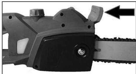
Рис. 7 Отключение тормоза цепи
