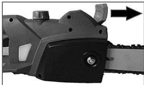
Рис. 8 Включение тормоза цепи
