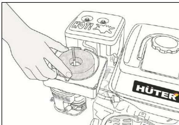
Рис. 15. Установка воздушного фильтра
