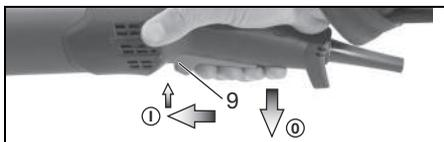
**Включение:** передвиньте вперед нажимной переключатель (9), затем нажимной нажмите вверх переключатель (9).
