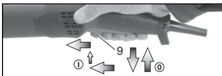
**Включение:** включите инструмент, как описано выше. Нажимной переключатель (9) передвиньте вперед еще на одну позицию и отпустите в этом положении, чтобы зафиксировать нажимной переключатель (9) (непрерывный режим работы).
