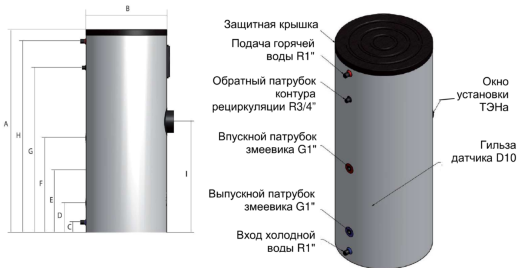
Водонагреватель с двумя теплообменниками-змеевиками 160-200 л
