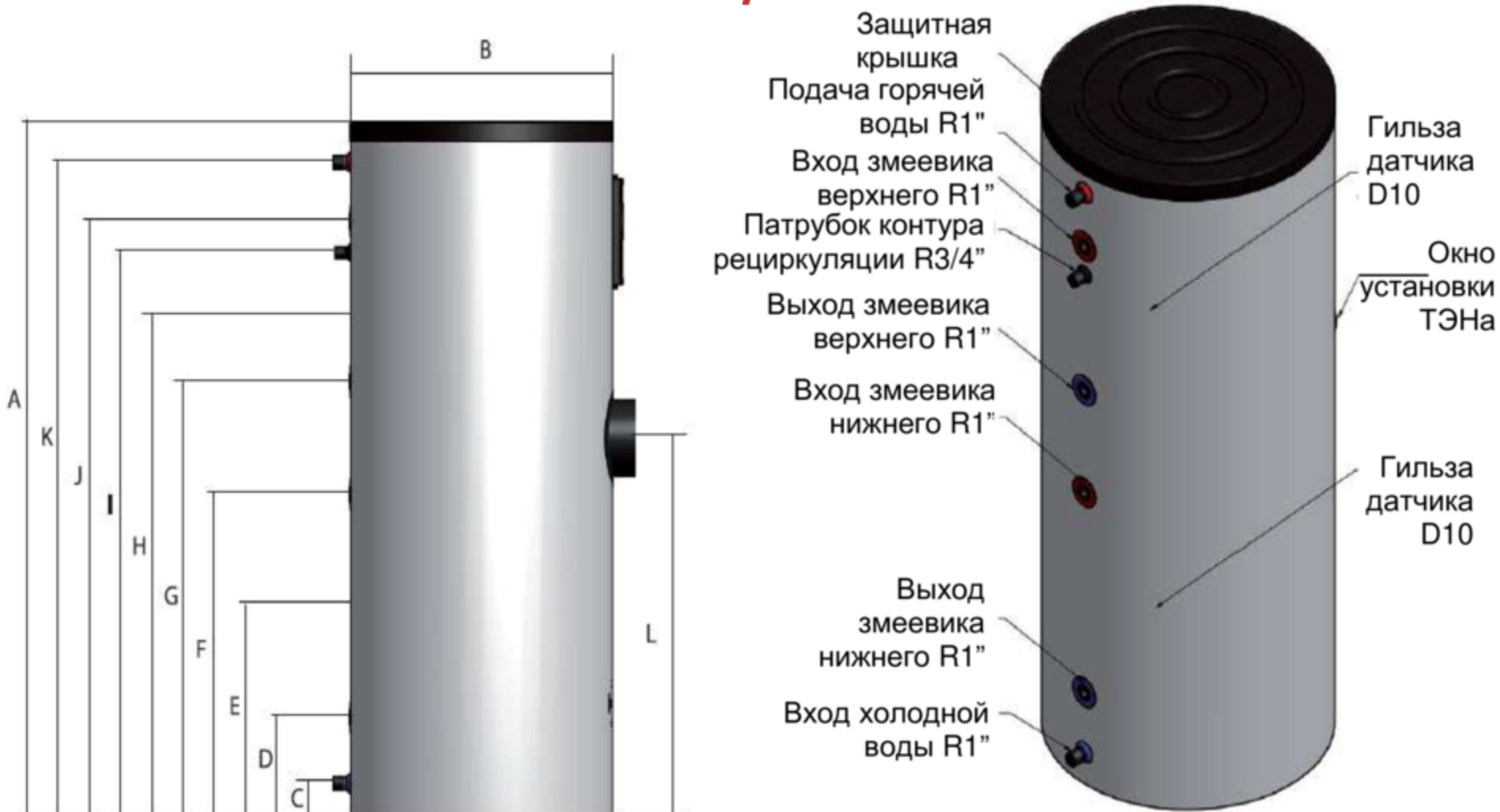
Водонагреватель с двумя теплообменниками-змеевиками 160-200 л
