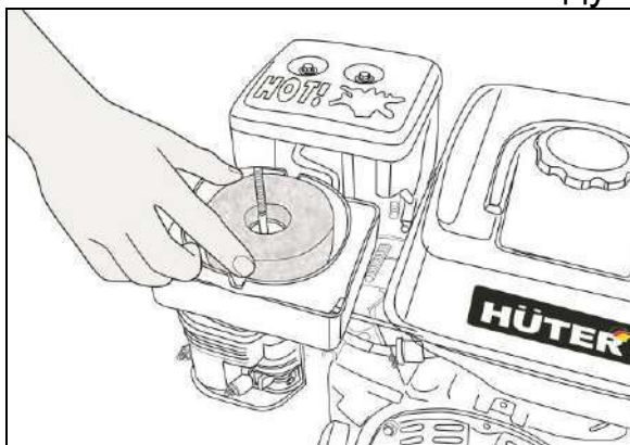
Рис. 40. Установка воздушного фильтра
