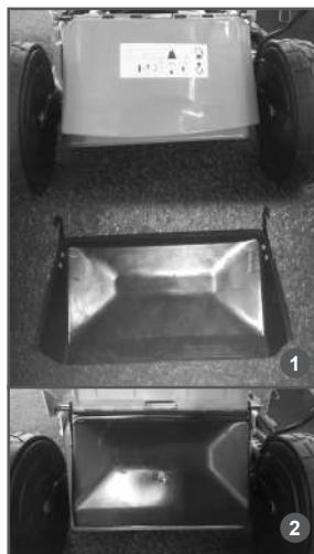
Рис. 4 Установка желоба заднего выброса
