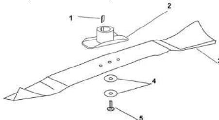
Рис. 18 Обслуживание ножа
