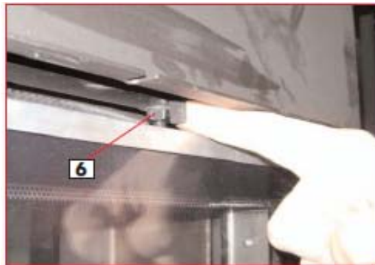
Рис. 1: стопорный рычаг заблокирован
