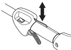
Проверьте, чтобы ручка газа и блокировочный рычаг перемещались свободно и чтобы возвратные пружины работали соответствующим образом.
