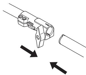
Перед использованием узла, хорошо затяните ручку.
