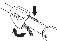
См. указания в разделе Запуск. Включите машину и полностью откройте дроссель. Отпустите рычаг дросселя и удостоверьтесь, что режущее оборудование останавливается и
