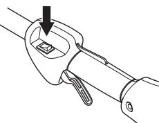
Запустите двигатель и проверьте, чтобы он остановился при переводе выключателя в положение стоп.
