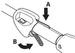
Проверьте, чтобы ручка газа в момент возвращения блокировочного рычага в исходное положение была блокирована на холостом ходу.
