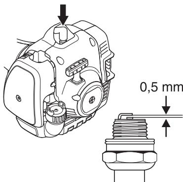
**ВНИМАНИЕ!** Всегда используйте только указанный тип свечи! Применение несоответствующей модели может привести к серьезным повреждениям поршня/цилиндра. Следите за тем, чтобы свеча была оснащена т.н. изоляцией радиопомех. Если вам требуется дополнительная информация, обратитесь к местному дилеру или в компанию Husqvarna.
