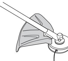
Проверьте, чтобы защита не была повреждена и чтобы на ней не было трещин. Замените защиту, если она была подвержена удару или если на ней есть трещины.
