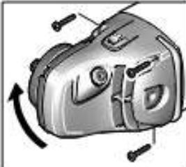
Редукторная головка может поворачиваться с интервалом в 90°. Таким образом выключатель может быть установлен в удобное для работы положение, например, для отрезных работ с вытяжным колпаком и направляющими салазками (21) или для левши.
